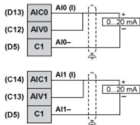
Tension et intensité pour les sorties analogiques
