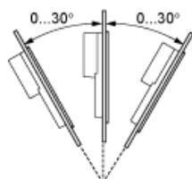
Lorsque le produit est installé en position inclinée à plus de 30°, la température ambiante ne doit pas dépasser 40 °C (104 °F). Vous pouvez utiliser un dispositif de refroidissement de l'air (ventilateur, climatiseur) pour garantir que la température de fonctionnement ne dépasse pas 40 °C (104 °F).
