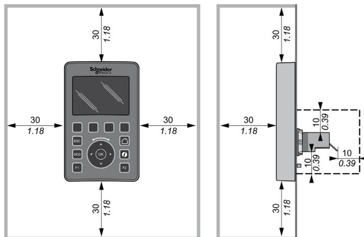
**NOTE :** Respectez les espacements appropriés pour permettre une ventilation suffisante et maintenir une température ambiante conforme aux caractéristiques environnementales (*voir page 16*).
