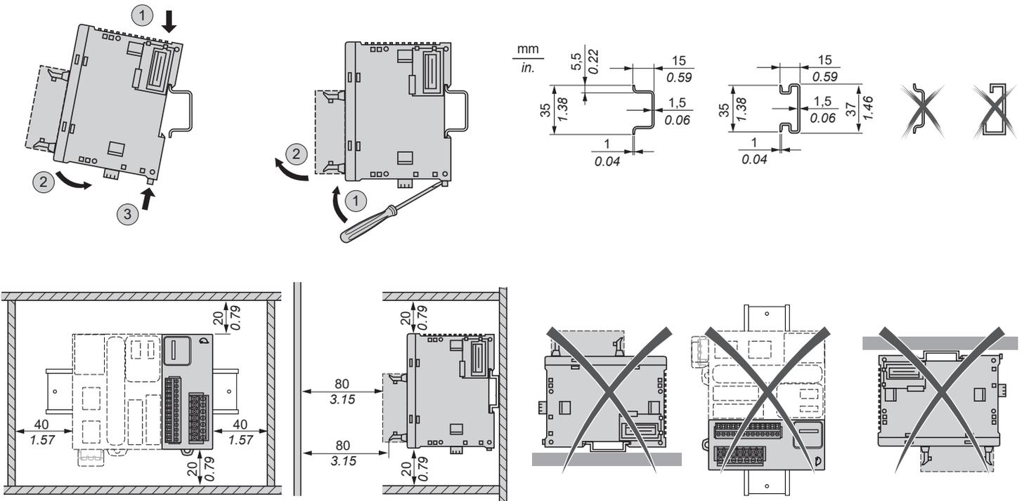
**Mounting on panel with attachment kit TMAM2 / TMAM2 Montagem em painel com kit de fixação TMAM2 / TMAM2 bağlantı kitıyla paneli monte etme**
