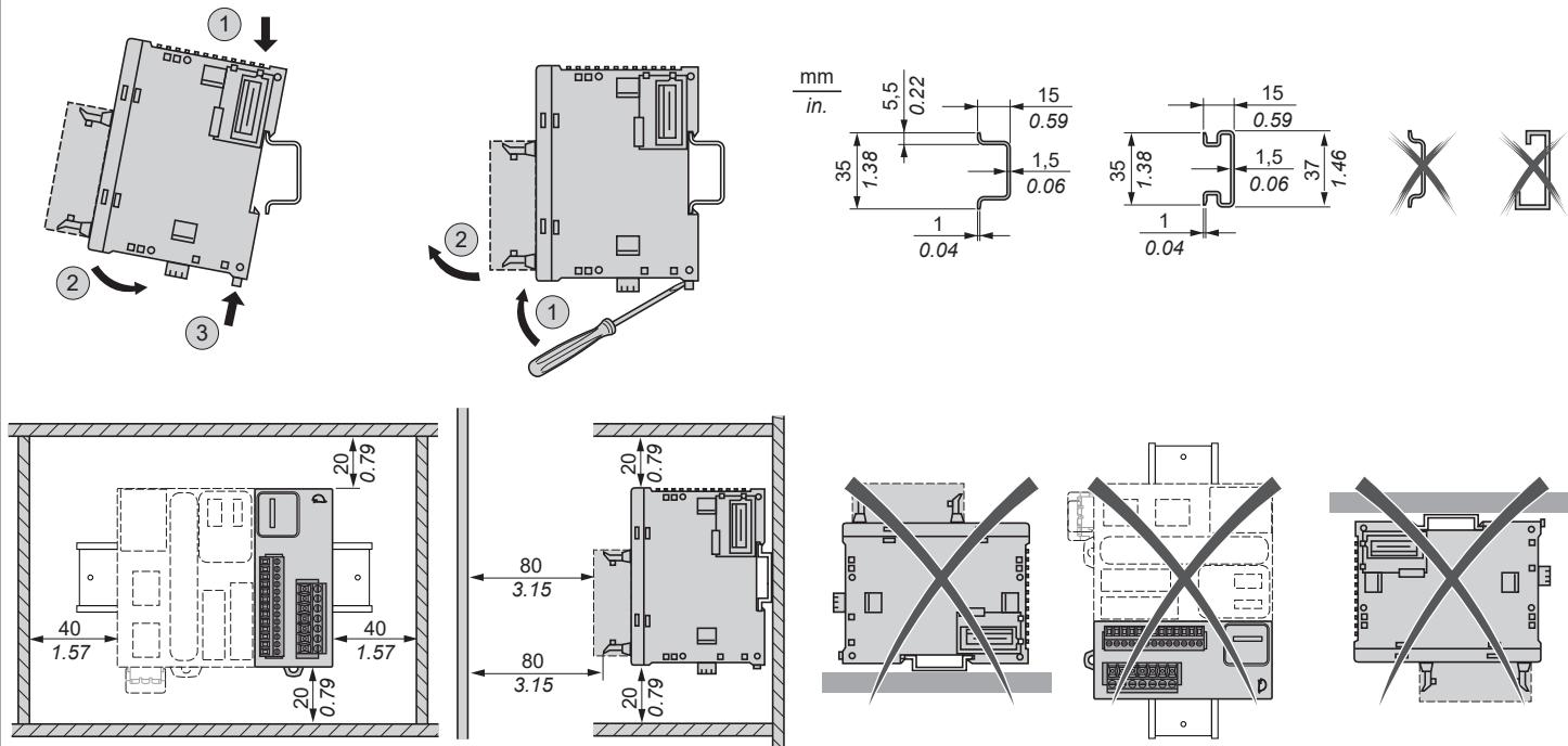
**Mounting on panel with attachment kit TMAM2 / TMAM2 Montagem em painel com kit de fixação TMAM2 / TMAM2 bağlantı kitile panel monte etme**
