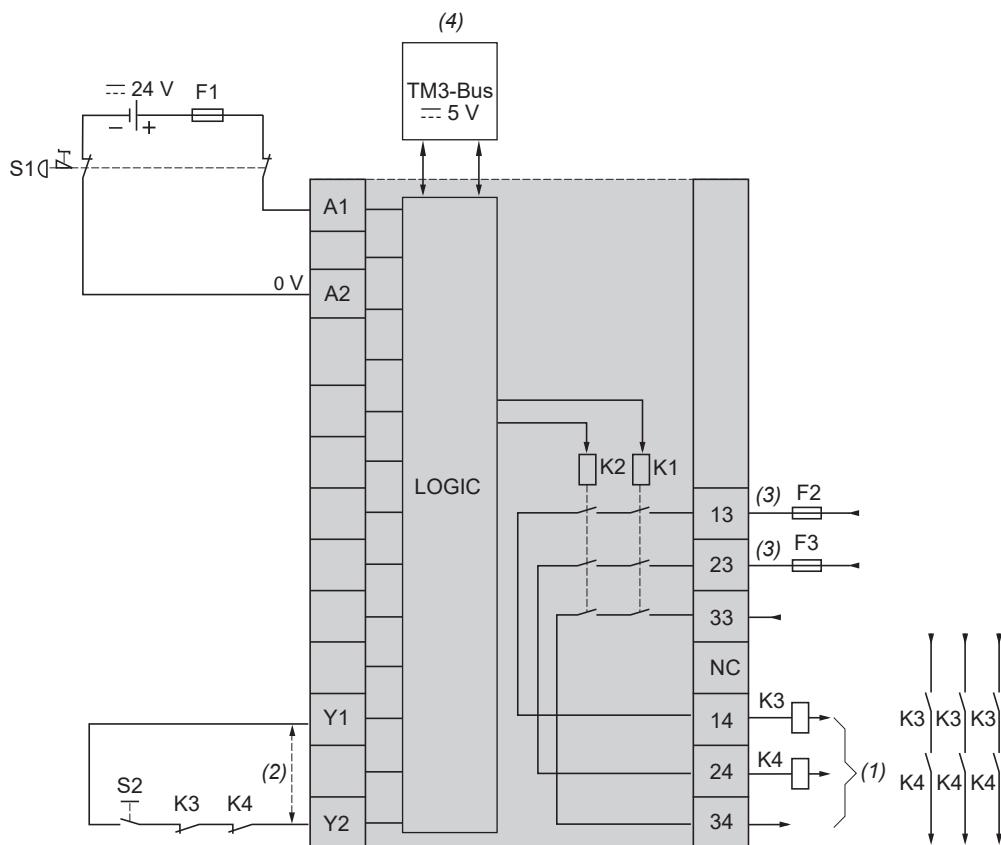
S1= EMERGENCY STOP / PARADA DE EMERGÊNCIA / ACİL DURDURMA / АВАРИЙНЫЙ ОСТАНОВ / ТӨТЕНШЕ ЖАГДАЙДА ТОҚТАТУ.
