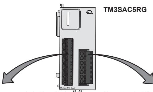
Spring terminal blocks 3.81 mm (0.15 in.) pitch / Blocos terminais de mola de passo de 3,81 mm / Yay terminal blokları 3,81 mm aralıklı / Пружинная клеммная колодка с шагом 3,81 мм / 3,81 мм ирек ойма қадамы бар серіппелі түйіспелер блоктары.
