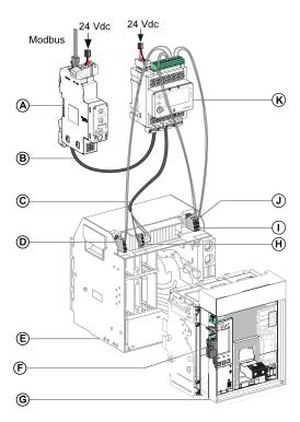
A Interface Modbus-SL IFM pour un disjoncteur
