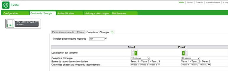
Le comptage d'énergie s'effectue par point de charge pour les bornes qui en disposent de deux. Il peut s'effectuer sans ajouter de compteurs lorsqu'il s'appuie sur la mesure du courant de charge par les transformateurs de courant intégrés à la borne et sur la mesure de tension de la phase neutre saisie dans **Tension phase neutre mesurée**.
