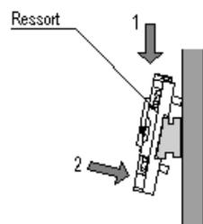
Montage et fixation du rack sur panneaux
