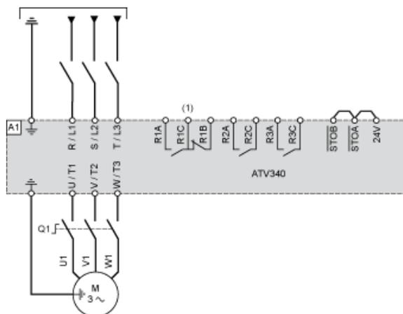
(1) Utilisez la sortie relais R1 réglée sur l'état de fonctionnement Défaut pour mettre l'appareil hors tension lorsqu'une erreur est détectée.
