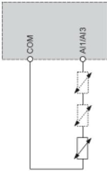
Il est possible de raccorder 1 ou 3 capteurs sur les bornes AI1/AI3.
