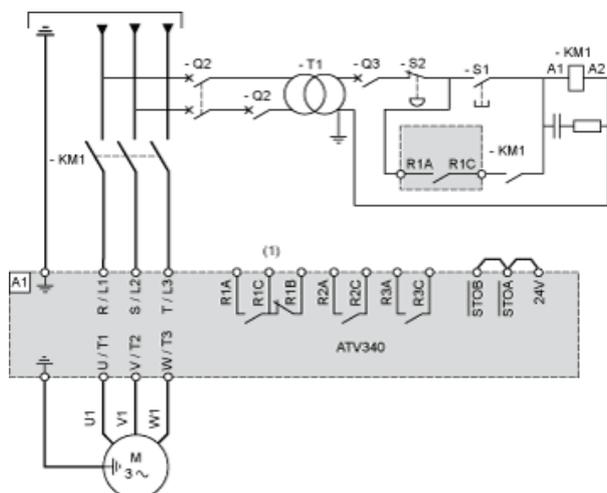
(1) Utilisez la sortie relais R1 réglée sur l'état de fonctionnement Défaut pour mettre l'appareil hors tension lorsqu'une erreur est détectée.
