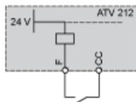
Position "PLC" avec sorties transistor de l'automate
