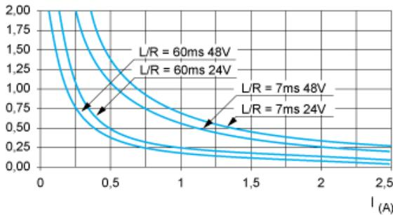
DC13 Commutation des électro-aimants,  $L/R \leq 2 \times (U_e \times I_e)$  en ms,  $U_e$  : tension nominale de fonctionnement,  $I_e$  : intensité nominale de fonctionnement
