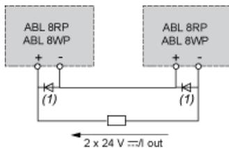
(1) Deux diodes Schottky I<sub>min</sub> = I<sub>n</sub> d'alimentation et V<sub>min</sub> = 50 V
