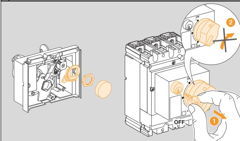
**came verrouillage "fermé" ou "ouvert" / fitting an open or close position key lock**
