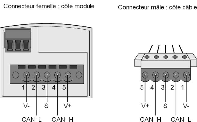
Le câble fin DeviceNet standard doit être utilisé pour connecter le TeSys U au réseau.
