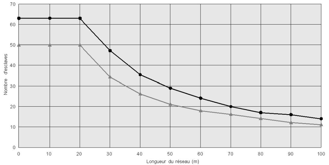
Si nécessaire, il est possible d'augmenter le nombre d'équipements TeSys U connectés au réseau DeviceNet à l'aide d'une deuxième alimentation DeviceNet.
