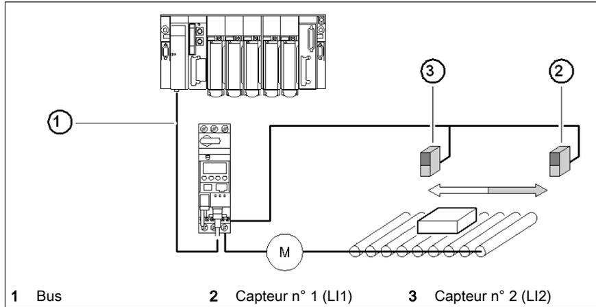
**NOTE :** Le capteur n° 2 (LI2) n'agit pas sur le sens direct et le capteur n° 1 (LI1) n'agit pas sur le sens inverse.
