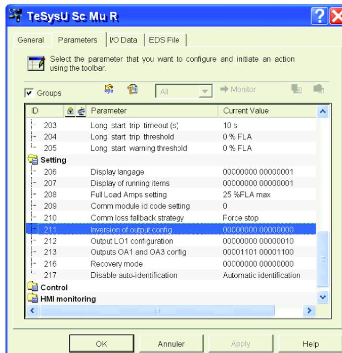
Lorsque vous sélectionnez un paramètre (les paramètres sélectionnés sont surlignés en bleu), vous pouvez appuyer sur les touches Ctrl + H pour accéder à un écran d'aide indiquant le numéro de registre :
