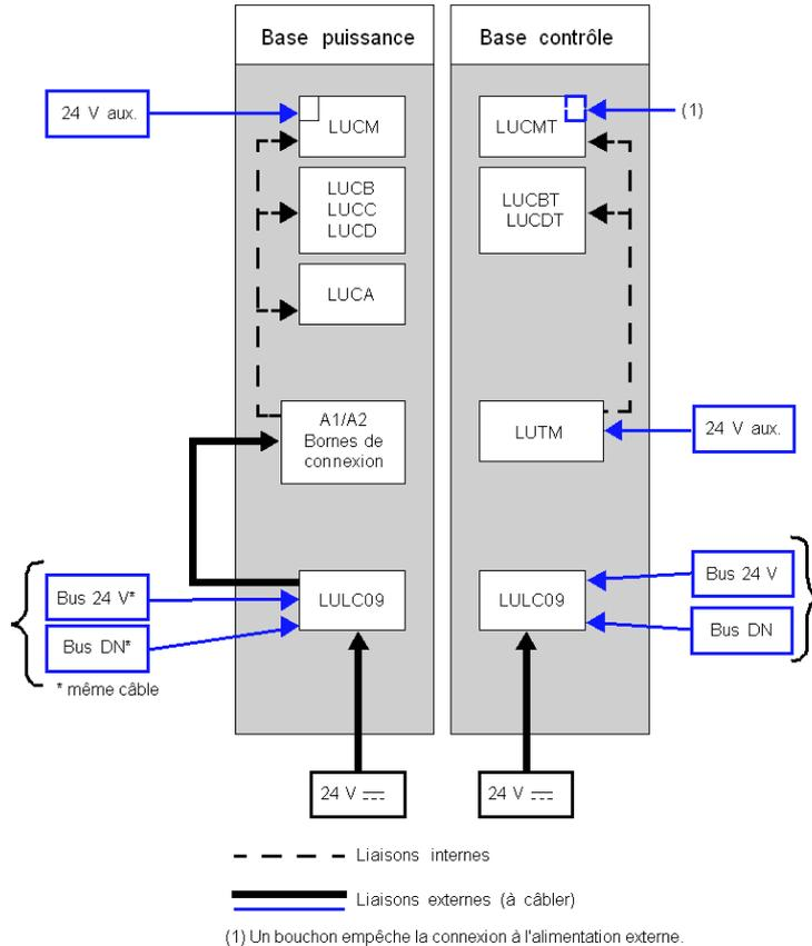
Bus 24 V = Alimentation du module de communication (V+ et V-)
