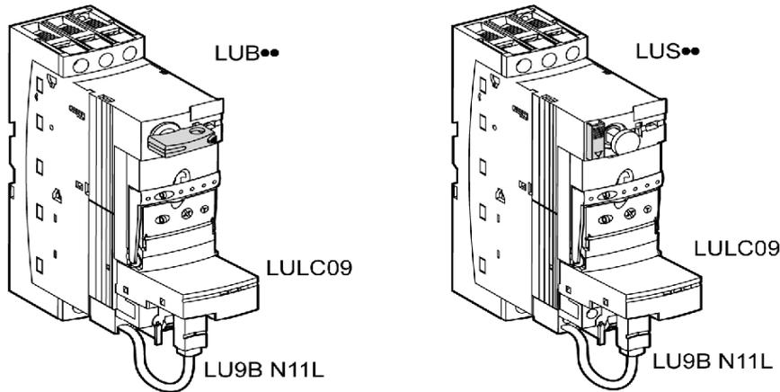
**Liaison fil à fil (alimentation des sorties OA1 et OA3 aux bornes de bobine A1, A2 et A3)**
