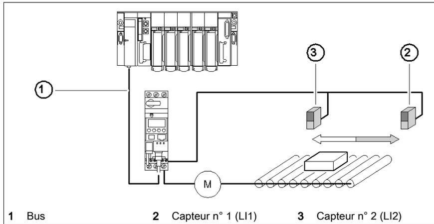
**NOTE :** Le capteur n° 2 (LI2) n'affecte pas la marche avant et le capteur n° 1 (LI1) n'affecte pas la marche arrière.
