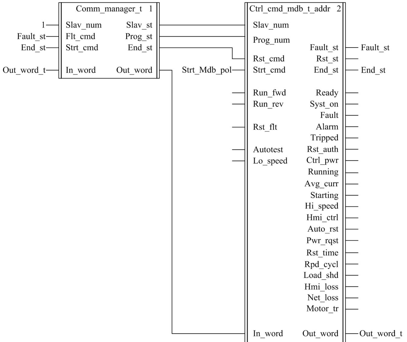
Le DFB Comm\_manager\_t peut être utilisé avec les démarreurs-contrôleurs TeSys U et les systèmes de gestion de moteur TeSys T présents sur le même réseau Modbus SL.
