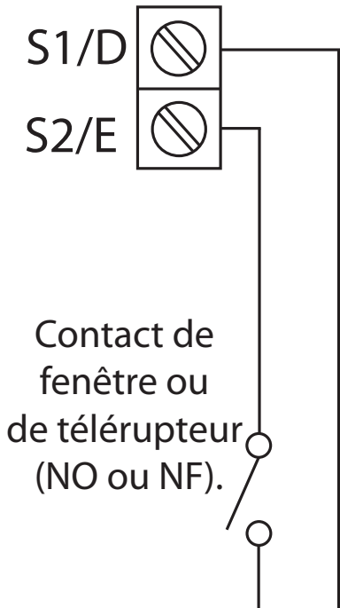
Configuration pour contact de fenêtre ou autre contact comme un télérupteur.
