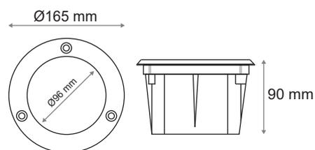
Pour les applications extérieures, un système de drainage doit être utilisé sous le socle d'encastrement pour faciliter l'évacuation des liquides.
