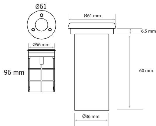
Pour les applications extérieures, un système de drainage doit être utilisé sous le socle d'encastrement pour faciliter l'évacuation des liquides.
