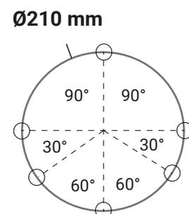
Schéma de pré-perçage de fixation
