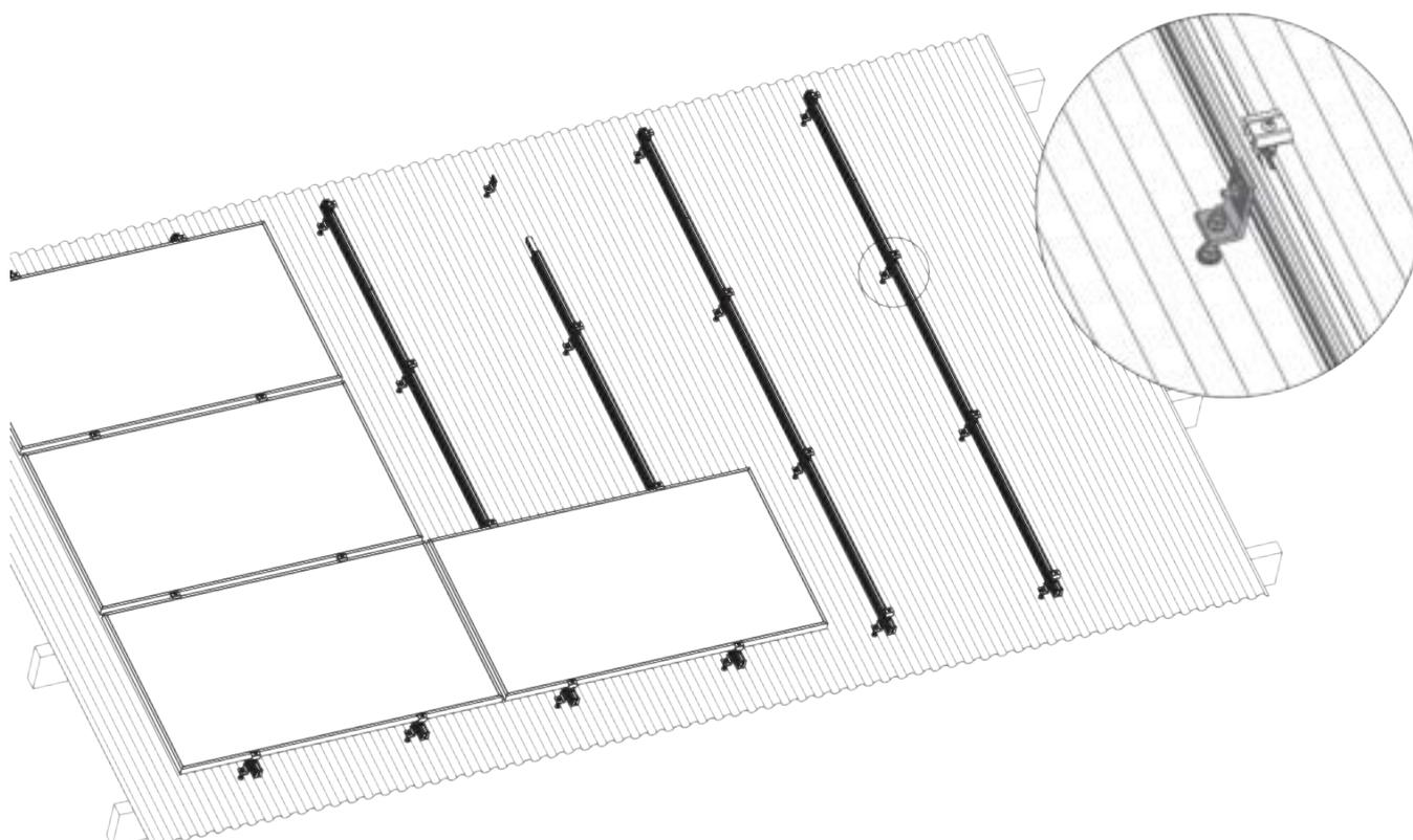
**Rails simples, pose en paysage, système de fixation tir fond à filetage bois ou fer**
