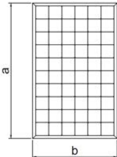
Si les points d'ancrage possibles sur la charpente ne permettent pas de respecter un écart maximum d'un mètre entre les crochets de toiture, adapter la charpente en conséquence ou poser vos rails en mode portrait si cela est faisable.
