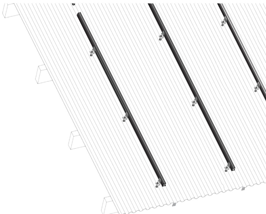
Préparation et montage de la fixation du tir fond à filetage bois ou fer
