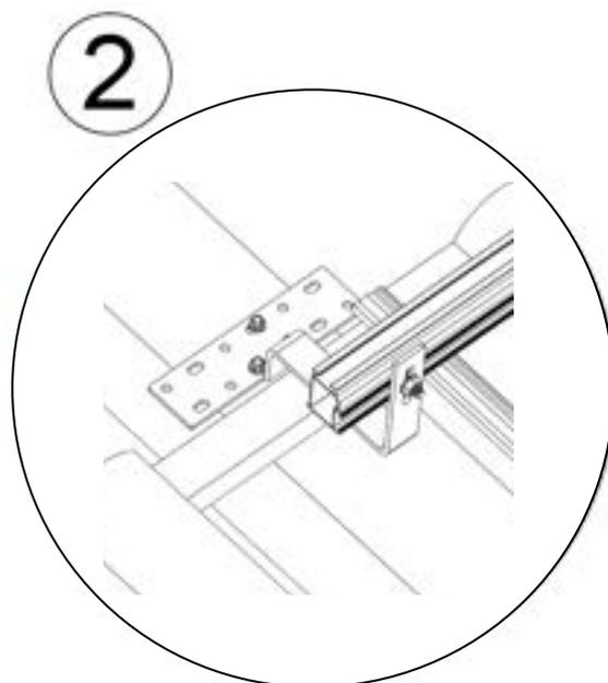
Pour le crochet standard ou pour le crochet réglable (« **TMH** ») mettre en oeuvre trois vis à bois quand la largeur de poutre le permet (1).
