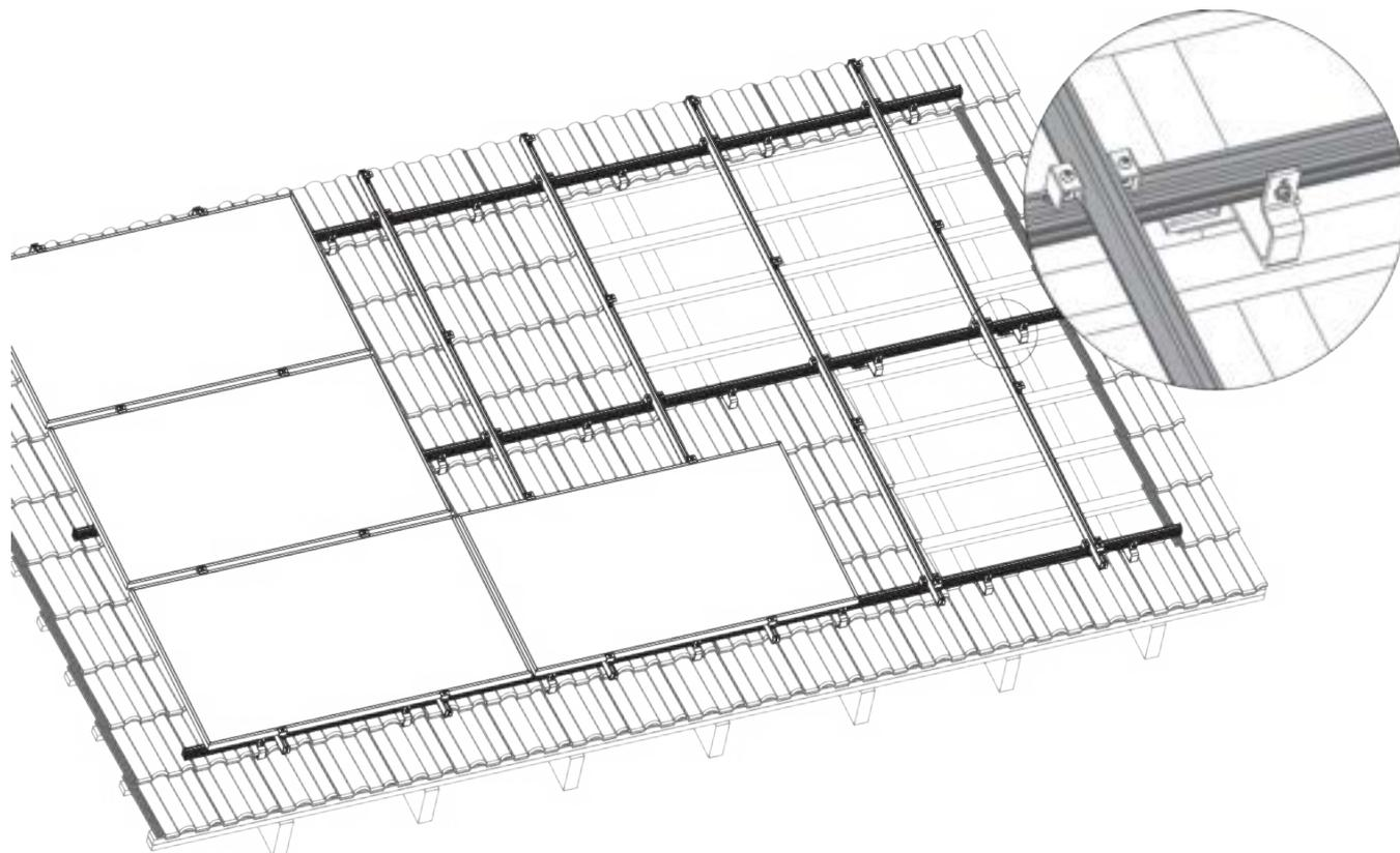
**Rails dans le sens du rampant, pose en paysage, système de fixation tir fond double filetage**
