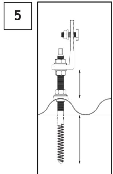
A propos de la pose des crochets de toiture
