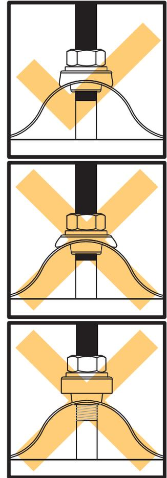
Attention, pour l'installation d'un tir fond sur support acier, il sera nécessaire de percer au préalable votre support
