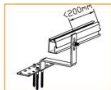
Sens de montage des rails et des crochets de toiture
