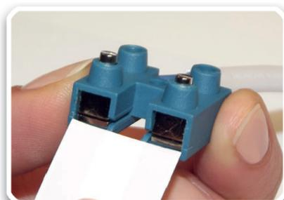
**5.** Insérer MAGIC ELEK dans le connecteur à travers la fente prévu pour le câble et dans le domino jusqu'au bord.
