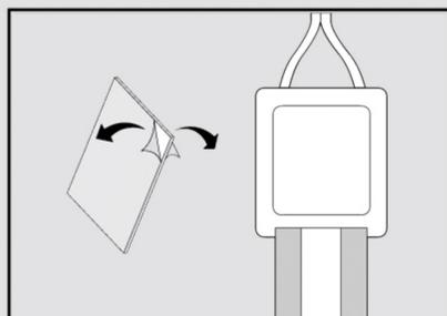
**1.** Fixer les connecteurs sur la surface ou le mur à l'aide de l'adhésif double face.
