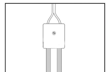
**7.** Fixer le connecteur B sur la surface ou le mur à l'aide du ruban adhésif double face.
