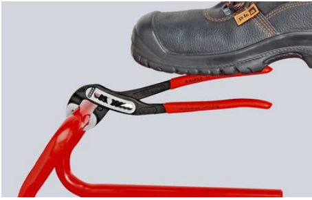
Autobloquante sur tubes et écrous : moins d'effort; l'intégralité de la force appliquée peut être utilisée pour faire tourner la pièce; inutile de trop serrer les poignées de la pince, effort nécessaire réduit
