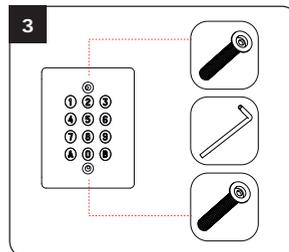
Passez le câble électrique du KCIN dans son ouverture et fixez le à son support par l'intermédiaire des vis Diax® et de l'outil spécifique Diax® (clé mâle coudée).
