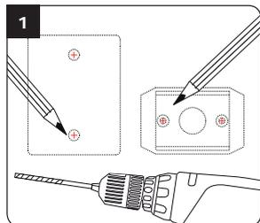
Vérifiez la distance entre le KCIN et son électronique déportée (Voir page 14 «Rappels et recommandations»). A l'aide de la plaque de fixation de l'électronique déportée et du KCIN, prenez les marques et percez les 2 trous de fixation (forêt Ø 5 mm et profondeur minimum = 35 mm) ainsi que l'ouverture pour le passage du câble électrique destiné au clavier.
