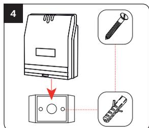
Positionnez les 2 chevilles plastique dans les trous. Puis fixez la plaque de fixation de l'électronique déportée sur la surface de votre choix, à l'aide des vis cruciformes à têtes fraisées. Venez ensuite placer l'électronique déportée sur son support.
