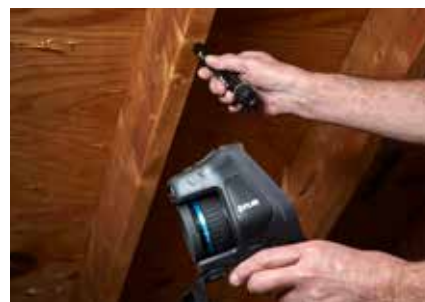
Utilisez le MR40 pour vérifier si le point froid identifié dans une image thermique est un indice d'humidité
