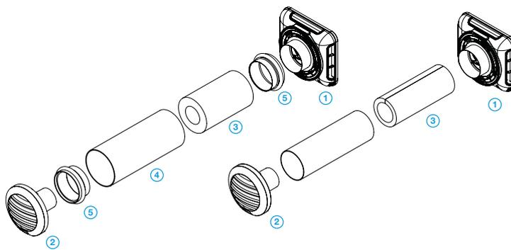
Composition entrée d'air EHT<sup>2</sup> et EFT<sup>2</sup>
