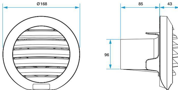
Encombrement Auvent EHT<sup>2</sup> et EFT<sup>2</sup>
