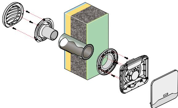
Mise en œuvre entrée d'air EHT<sup>2</sup> et EFT<sup>2</sup>
