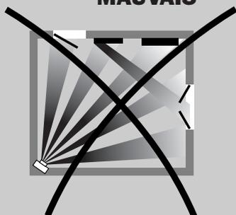
Le détecteur fait face à un miroir (réflétant les rayons du soleil) et à une cheminée. L'axe de passage ne coupe pas latéralement les faisceaux.
