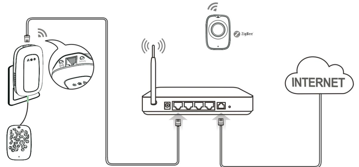
Branchez le câble RJ45 sur votre box internet. Connectez le câble RJ45 sur la base Senso Kit. Connectez le détecteur de température. Branchez la base Senso Kit sur une prise de courant. Installez le détecteur de température sur une surface plane. Installez les piles dans le détecteur de mouvements, la LED bleue clignote. Pour l'appairer avec la base, appuyez 3 secondes sur le bouton ((•)).
