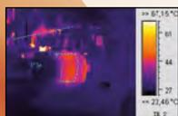
Les **DiaCam** permettent de réaliser des vérifications et contrôles sur des pièces et ensemble mécaniques : points d'usure, mauvais alignement d'arbre, problème de lubrification, etc.
