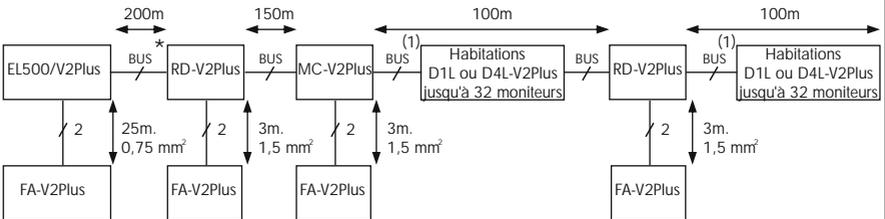
**H: Répéteur en cascade (96 éléments par vertical / 500 mètres):**
