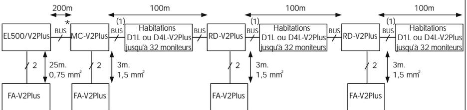
(1) Important: Ne pas dépasser le nombre max. de moniteurs/postes d'appel connectés à une plaque/multiplexeur/répéteur, ou les distances indiquées pour plaque/multiplexeur/répéteur et le dernier moniteur et entre les moniteurs de différents habitations connectés à la plaque/multiplexeur/répéteur. Pour les caractéristiques, sections et distances voir le manuel de produit correspondant.
