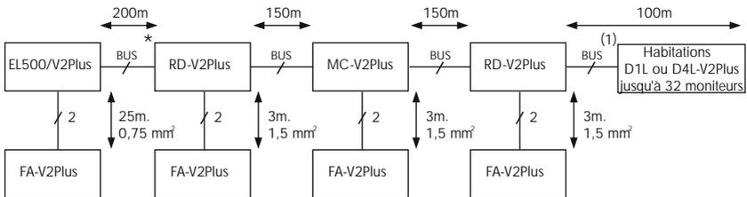
**G: Répéteur en cascade (64 éléments par vertical / 550 mètres):**
