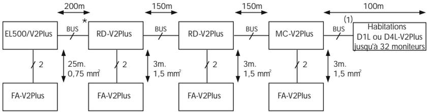
**F: Répéteur en cascade (32 éléments par vertical / 600 mètres):**
