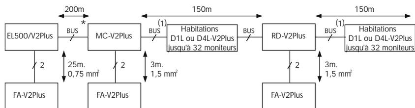
**D: Répéteur en cascade (32 éléments par vertical / 600 mètres):**
