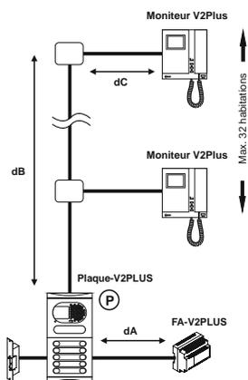
**IMPORTANT:** La distance à augmenter par le répéteur dépendra de la section du câble installé.
