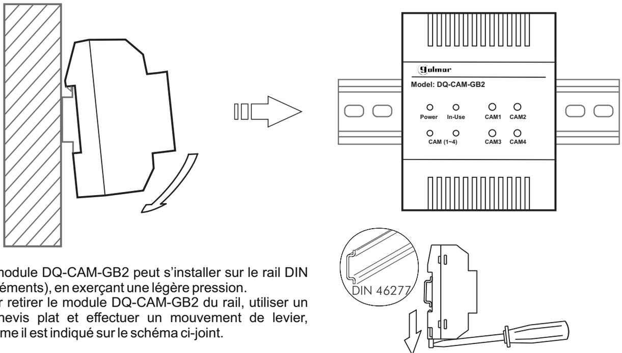
Le module DQ-CAM-GB2 peut s'installer sur le rail DIN (4 éléments), en exerçant une légère pression. Pour retirer le module DQ-CAM-GB2 du rail, utiliser un tournevis plat et effectuer un mouvement de levier, comme il est indiqué sur le schéma ci-joint.
