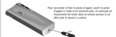
Éviter les emplacements trop proche d'une source de chaleur, de poussières ou exposé à la fumée. Le poste d'appel peut être installé directement sur un mur: Pour le fixer directement au mur, réaliser deux trous de 6mm. Sur les positions à cet effet, en utilisant des chevilles de 6mm et des vis de Ø3,5 x 25mm.
