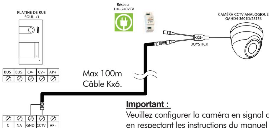
**Configuration du signal de sortie analogique CVBS**
