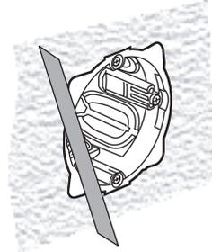
Vérifier que le mur est parfaitement plat autour des boîtes d'encastrement avec une règle ou un niveau.
