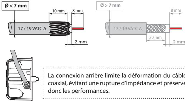
La connexion arrière limite la déformation du câble coaxial, évitant une rupture d'impédance et préserve donc les performances.
