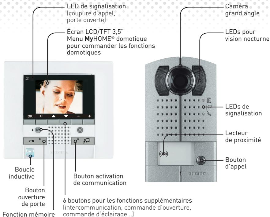
**CONTENU DU KIT :** Poste intérieur Polyx Memory Display - Platine de rue Linea 2000 - Alimentation Bus 2 fils - Adaptateur vidéo - 6 badges de proximité - 2 puces électroniques - Relais d'ouverture de porte
