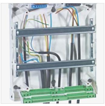
Le passage des câbles peut être réalisé par le haut ou le bas du coffret lorsque celui-ci est fixé au mur et par le fond du coffret lors du montage sur goulotte GTL.
