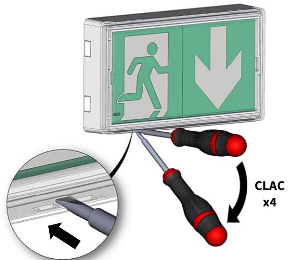
Tournevis recommandé : Tournevis pour vis à fente Ø 0.8 x 4 x 100 mm
