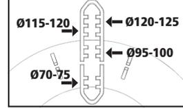
Insérer en force les 3 clips dans les encoches en fonction du diamètre intérieur de votre manchette.
