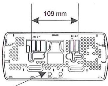
Le fond en « nid d'abeille » permet de faciliter la fixation lors du remplacement d'un produit existant.
