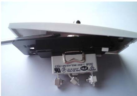
**Positionner le tournevis entre le mécanisme et la façade dans l'encoche prévue à cet effet et faire doucement levier pour déclipser la façade**
