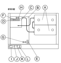
A - Batterie d'accumulateurs cadmium-nickel étanches (à recombinaison) en tampon. Ne nécessite aucun entretien.
