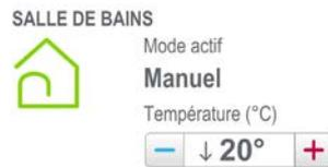
**NOTE :** Dans ce cas, il n'est plus possible de contrôler la température à l'aide des réglages (ordres) du fil pilote.
