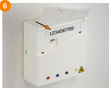
6 Poser les étiquettes d'identification sur le capot (une étiquette collée sous la trappe et l'autre collée à l'intérieur du capot).
