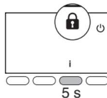
Lorsqu'un défaut est présent sur l'installation, le symbole
