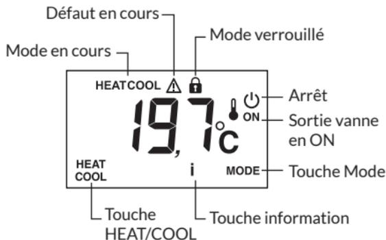
**Touche HEAT/COOL** : apparaît en mode OFF, si le thermostat est de type «Master» et selon la configuration de l'installation. Appuyez 3 secondes sur la touche pour basculer d'un mode à l'autre.
