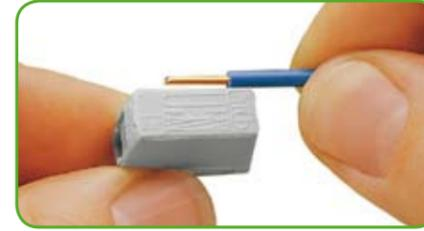
La longueur de dénudage est de 9 à 11 mm. La mesure peut être faite grâce à la toise intégrée à la borne.
