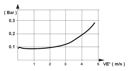
VE\* : Vitesse équivalente ( vitesse moyenne dans la section d'entrée )
