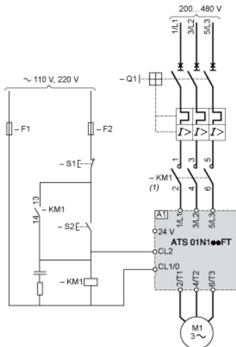
(1) Un contacteur de ligne doit être utilisé dans la séquence.
